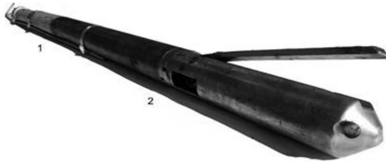
Рисунок – Скважинный вибрационный источник: 1 – дебанасный генератор колебаний; 2 – электромеханическое прижимное устройство
